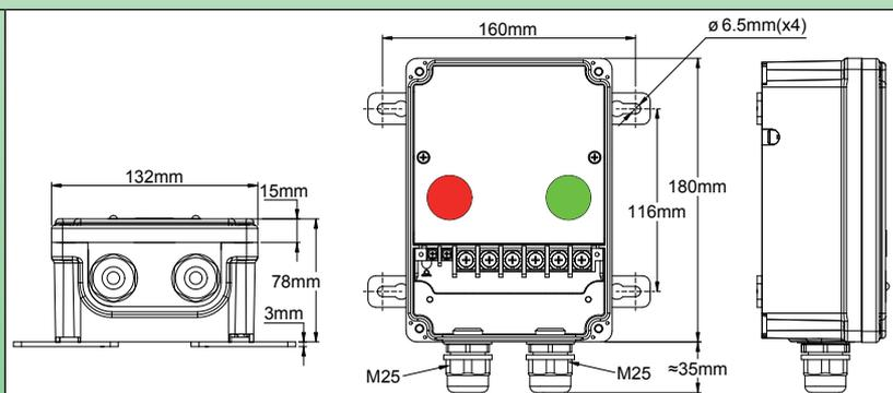
3 × 25A (AC1), 250V, 接线端子带有两个 2.5mm<sup>2</sup> 螺丝端子和 6 个 10mm<sup>2</sup> 的螺丝端子。红色指示灯是电源灯，而输出则是绿灯 (250V)，透明盖子。
