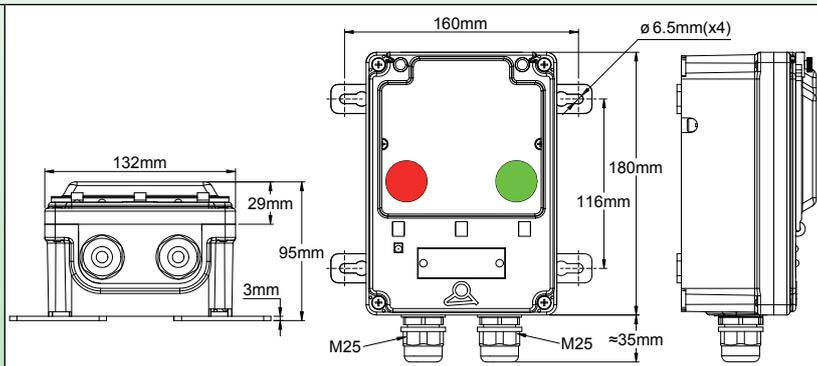
3 × 16A (AC1), 250V, 接线端子带有 5 个 2.5mm<sup>2</sup> 螺丝端子和 5 个 6mm<sup>2</sup> 的螺丝端子。红色指示灯是电源灯，而输出则是绿灯 (250V)，透明盖子。
