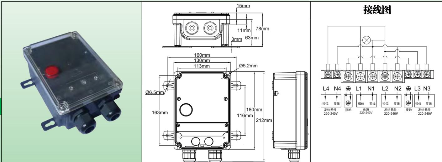
**接线:** 电源零线 + 相位 + 在一个 6mm<sup>2</sup> 端子接线柱接地，并且出口连接到 3 个加热电路出口 1.5 或 2.5mm<sup>2</sup>。
